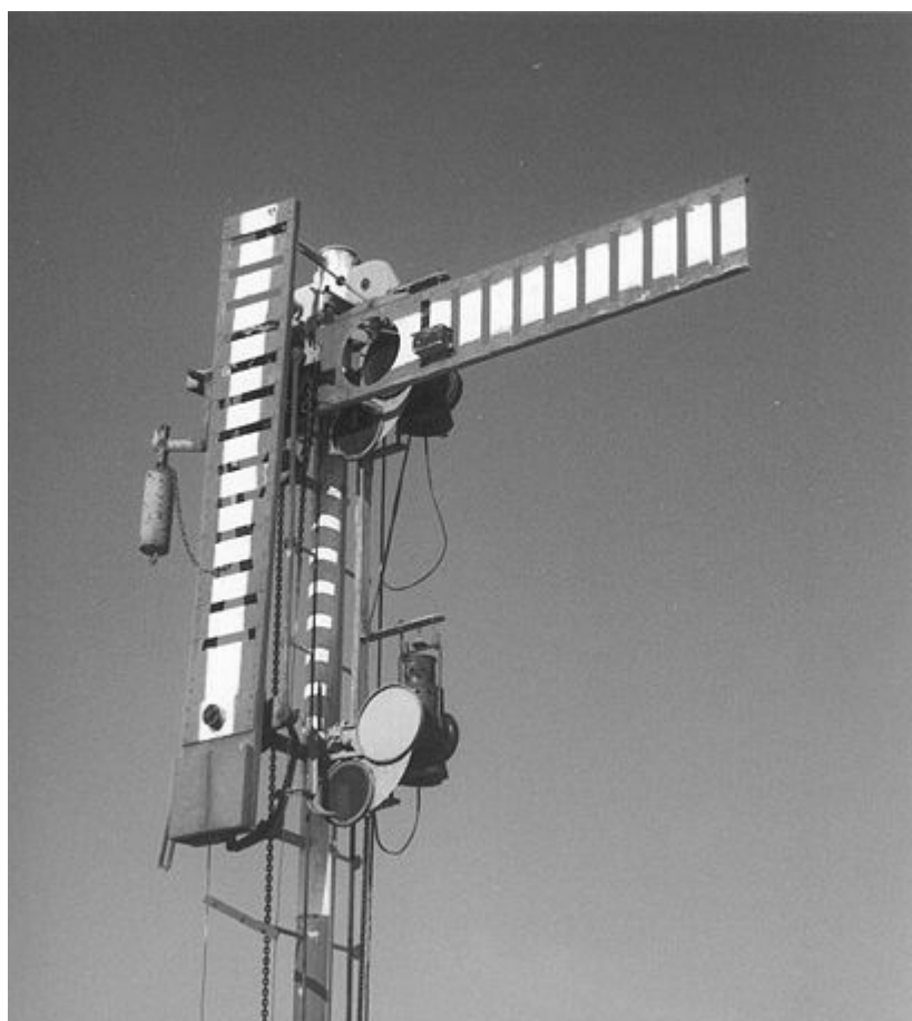
Obr.2.4. Stav mechanického dvojramenného návěstidla.
